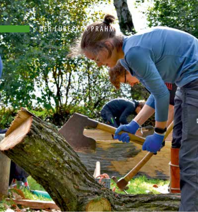
Mit dem Beil werden die Spanten des Prahms aus krummen Holzstämmen herausgearbeitet. Hunderte von eisernen Kalfatklammern werden von den Teilnehmenden von Hand geschmiedet.
